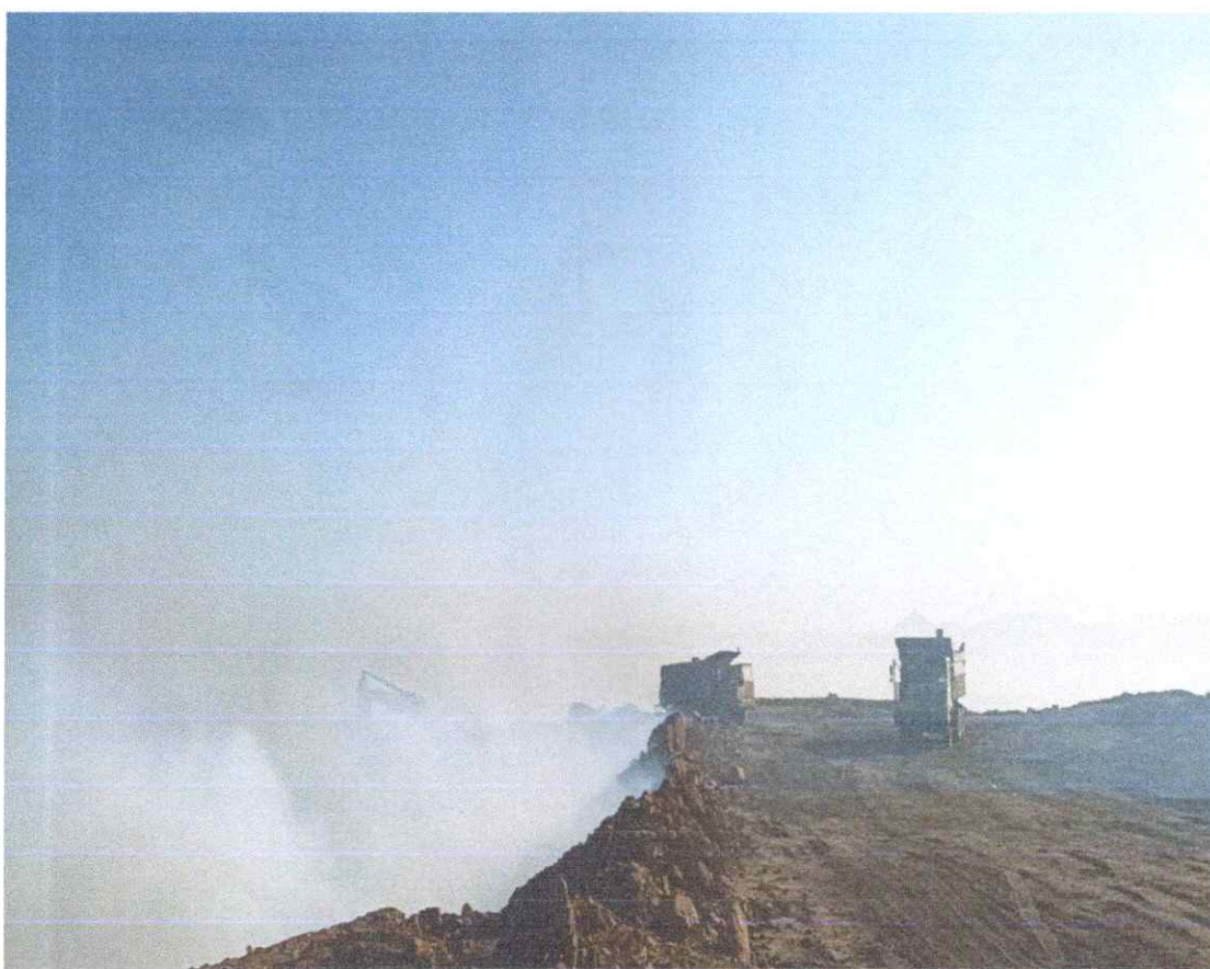
剥挖转排过程自卸车轮胎自燃
