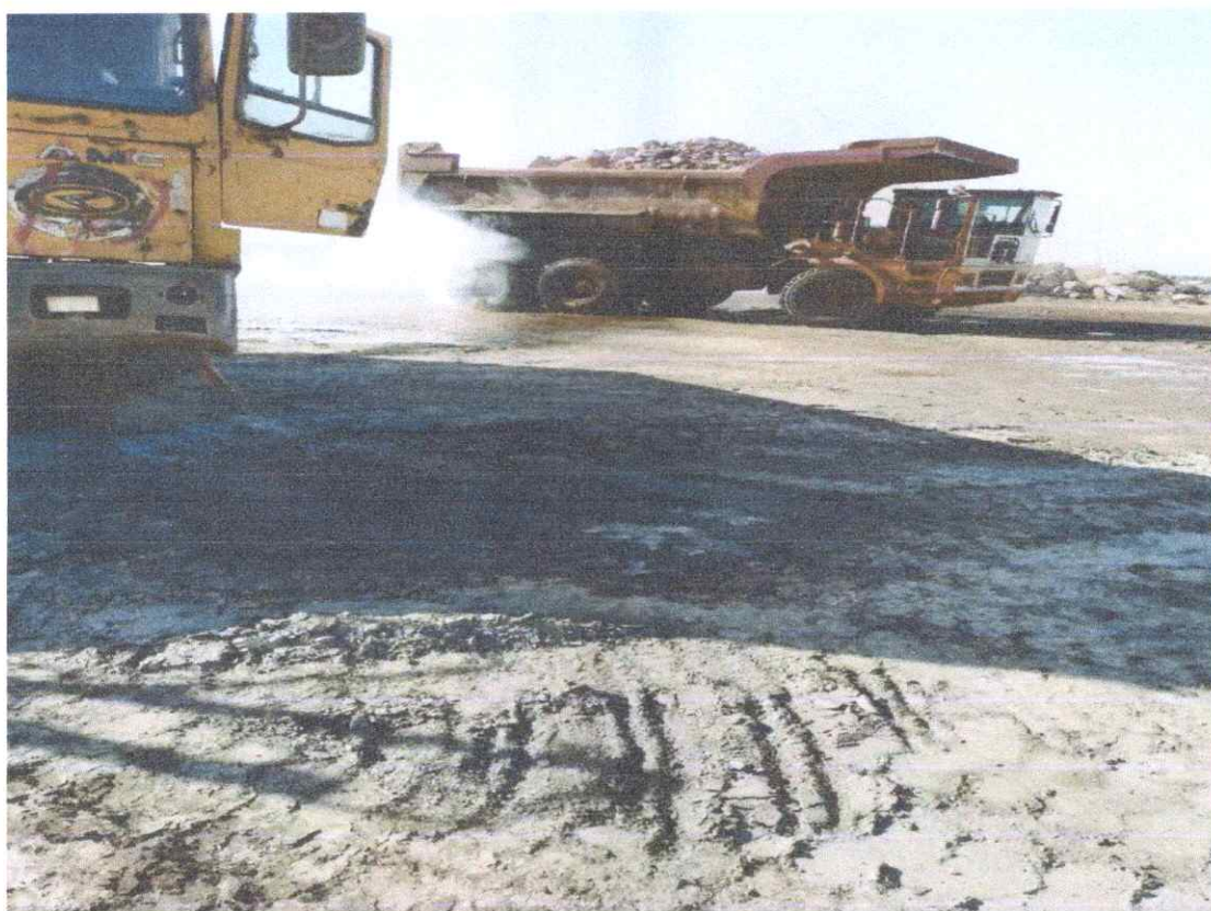
剥挖转排过程自卸车轮胎自燃
